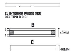
Paneles encolados y prensados al bastidor de madera.
